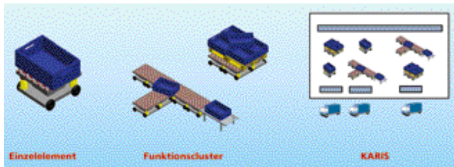
2 Aufbauschema des neuartigen Intralogistik-Systems KARIS
