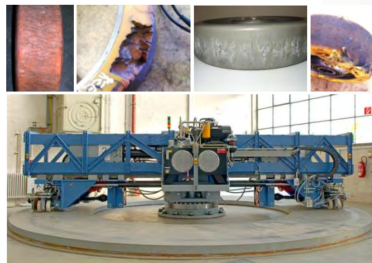
Neuartiger Kreisaktorprüfstand zur Untersuchung von Rädern und Rollen am IFT
