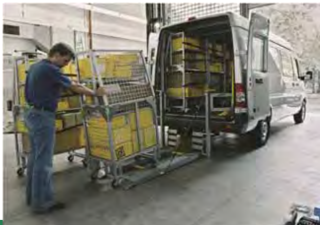
Konzeption und Funktionsprinzip einer neuen Hubeinrichtung für Sprinterfahrzeuge der DaimlerChrysler AG
